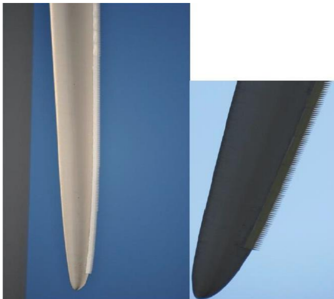
Figure 4. Exemple de serrations mis en place sur les éoliennes (source Vestas)
